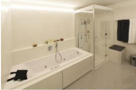
(6-6) Individuell gefertigtes Dampfbad mit Duschwanne aus Mineralwerkstoff, Dampfpaneel Atlanta, geflieste Sitzbank, Glastür (Steam Door) mit Siebdruck und Licht. Dazu eine Badewanne mit Massagefunktionen.
