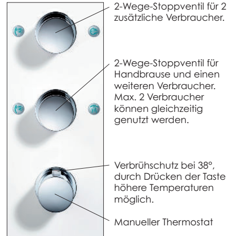
Thermostat mit zwei 2-Wege-Stoppventilen
