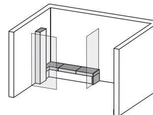
Ecksitzbank mit Anschluss an Paneel HALIFAX, dargestellt Ausrichtung Paneel links, Sitz rechts mit einem Glasausschnitt mit Sockelwange (nur zur Kombination mit STEAM DOOR mit Siebdruck (Höhe 230 cm))
