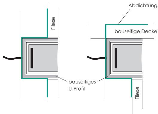
aufgesetzt auf Fliese, Kabelführung durch Decke
