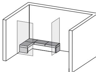
Ecksitzbank mit einem Glasausschnitt mit Sockelwange und Abschluss in der Kabine (Länge und Breite nicht kürzbar)
